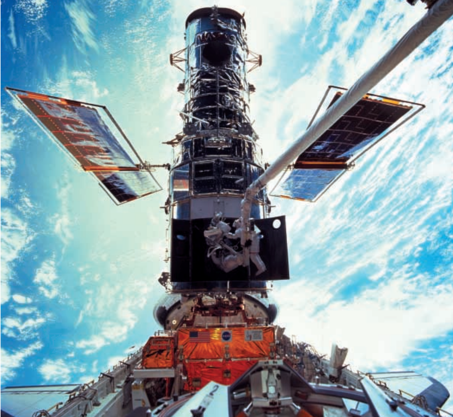
Abb. 2: Das HST in seiner Umlaufbahn während einer Wartungsmission. Astronauten befinden sich ausserhalb des Shuttles, um neue Instrumente zu installieren. Unsere Erde bietet einen spektakulären Hintergrund. Eine neue Wartungsmission im Jahr 2004 soll das HST mit einer empfindlicheren Kamera, der Wide-Field-Camera 3, ausstatten, welche vom ultravioletten bis zum nah-infraroten Wellenlängenbereich arbeitet. Bild: NASA
