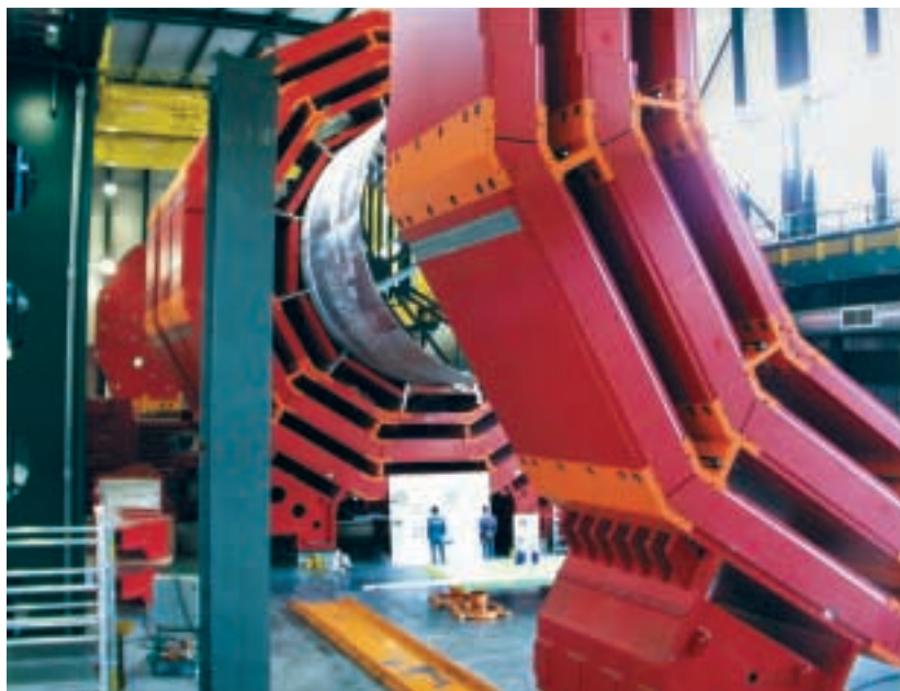
Abb. 3: Das zurzeit im Bau befindliche Compact-Muon-Solenoid-Experiment (CMS) ist eine der beiden Grossdetektoranlagen am zukünftigen Large Hadron Collider (LHC). Das Bild zeigt die vollständig zusammengebauten Ringe des CMS-Barrel-Magneten und die äussere Schale des Vakuumtanks, welcher am zentralen Ring befestigt ist.
